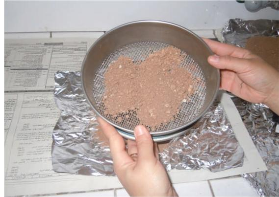
**Photo 1 :** Séchage du sol à température ambiante      **Photo 2 :** Tamisage du sol à 2 mm
